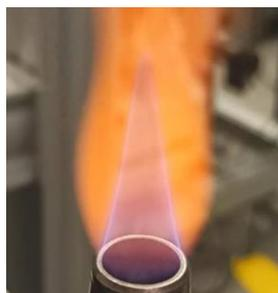
Рис. 1. Фотография ламинарного газочапельного пламени Бунзена.
