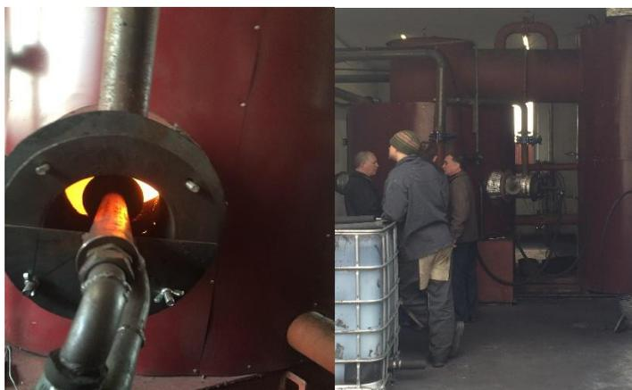
Рис. 1. Процесс сжигания водоугольного топлива в вихревой камере.
