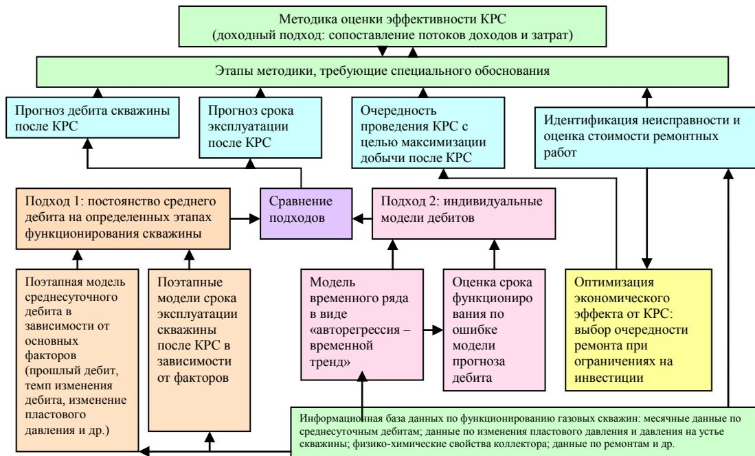
Рис. 17. Схема адаптации методики стоимостного подхода для оценки эффективности проведения капитального ремонта газовых скважин
